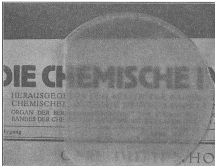
Abb. 11. Durchsichtigkeit einer 1 cm starken Tafel Weichparaffin, das durch die frühere Winterkristallisation erzeugt wurde.
